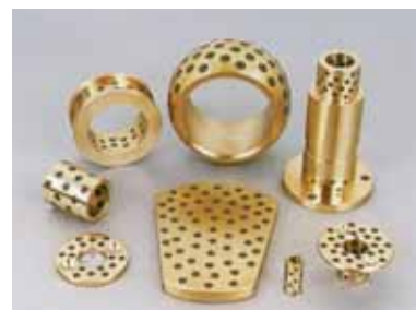
JDB-2 Bronslegering med fasta smörjmedel. Bärighet 60N/mm 2 . Temperaturområde >350°C. Max hastighet 2 m/s
