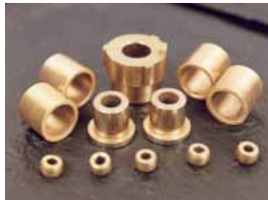
FU-1 Oljeimpregnerad sinterbrons Bärighet 35N/mm 2 . Temperaturområde -80°C ~ +160°C
