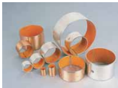
NB2S Smörjfri, rostfri Bärighet 70N/mm 2 . Temperaturområde -40°C ~ +130°C. Max hastighet 5 m/s
