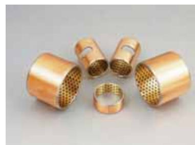
FB08G Stål/bly/brons med fasta smörjmedel. Bärighet 65N/mm 2 . Temperaturområde -100°C ~ +260°C Max hastighet 4 m/s
