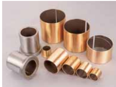
NB1B Högtemperatur Bärighet 140N/mm 2 . Temperaturområde -195°C ~ +300°C. Max hastighet 5 m/s
