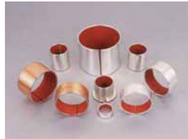
NB1D Hydraulikbussning (BP4) Bärighet 140N/mm 2 . Temperaturområde -195°C ~ +280°C. Max hastighet 3 m/s
